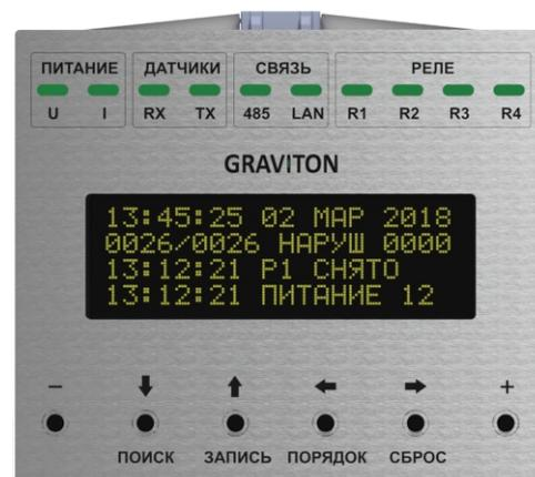
Контроллер адресной линии GRAVITON Modbus с поддержкой Modbus TCP
