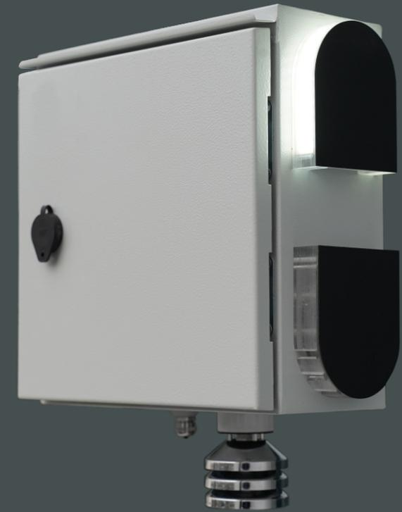
Станция представляет собой герметичный металлический бокс, в котором находятся измерительные модули, микроконтроллер, система стабилизации температуры, блок питания и GSM \ LTE \ NB-IoT \ Wi-Fi модем. Лёгкий доступ к внутренним компонентам станции, при техническом обслуживании, обеспечивается открывающейся створкой
