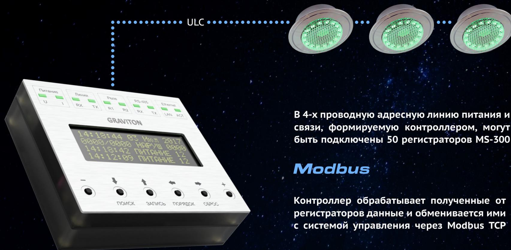
В 4-х проводную адресную линию питания и связи, формируемую контроллером, могут быть подключены 50 регистраторов MS-300
