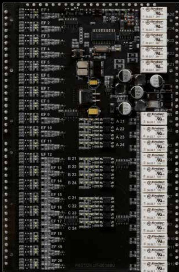
Модуль DF обменивается информацией о состоянии 20 шлейфов с модулем (Е) по интерфейсу RS-485.
