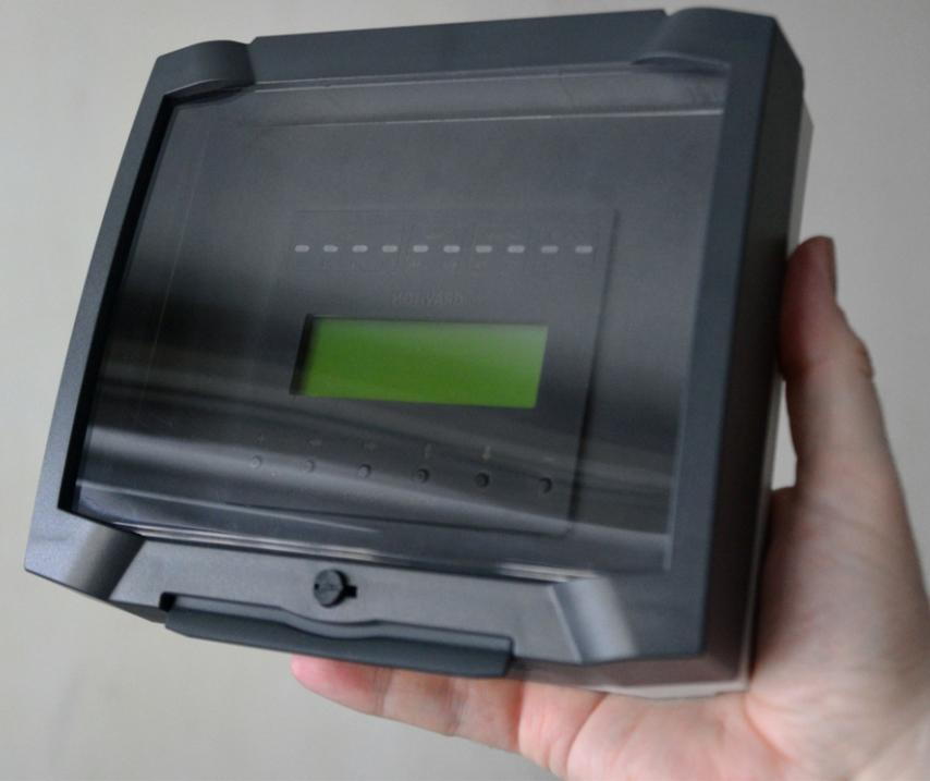
Контроллер размещается в герметичном пластиковом боксе, в котором находится источник питания и панель коммутации с клеммами быстроразъёмного соединения. Лёгкий доступ к внутренним компонентам обеспечивается открывающейся створкой.
