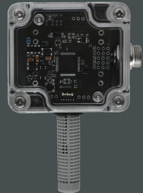
Мультисенсорный регистратор представляет собой пластиковый бокс с разъёмом, зондом для забора воздуха и прозрачной верхней крышкой, позволяющей определить уровень запылённости измерительной камеры. Внутри бокса находится система принудительного забора воздуха, измерительные модули, LED индикатор, блок питания и микроконтроллер
