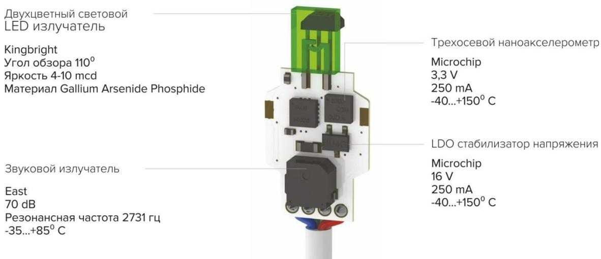
Рис. 2. Плата извещателя с радиоэлектронными компонентами. Сторона 1.
