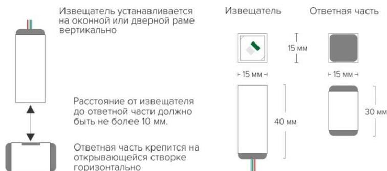
Рис. 9. Модификация извещателя для накладного монтажа
