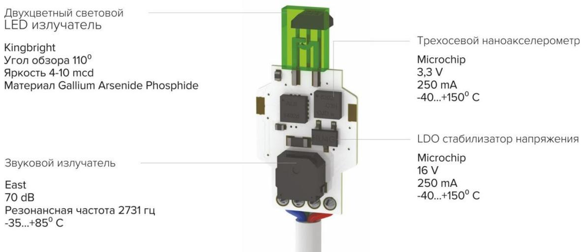
Рис. 2. Плата извещателя. Сторона 1.
