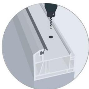
В раме окна или двери просверлите сквозное отверстие диаметром 13 мм.
