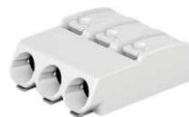
Быстрозажимные соединители WAGO позволяют подключать провода, сечением от 0,15 до 0,75 мм<sup>2</sup>
