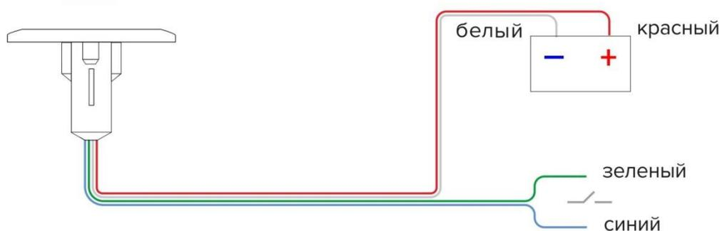
Рис. 6. Включение извещателя для работы в аналоговом режиме.
