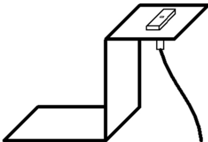
Рис. 4. Кронштейн для проверки извещателя
