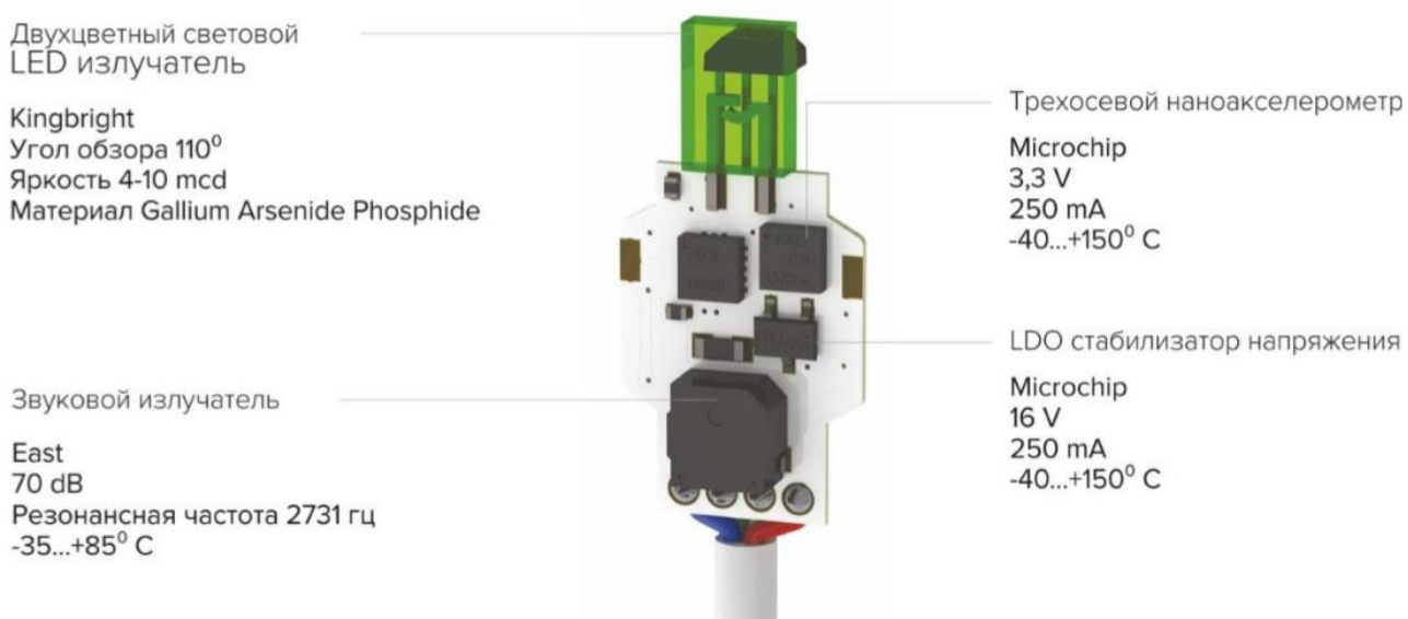
Рис. 2. Плата извещателя. Сторона 1.
