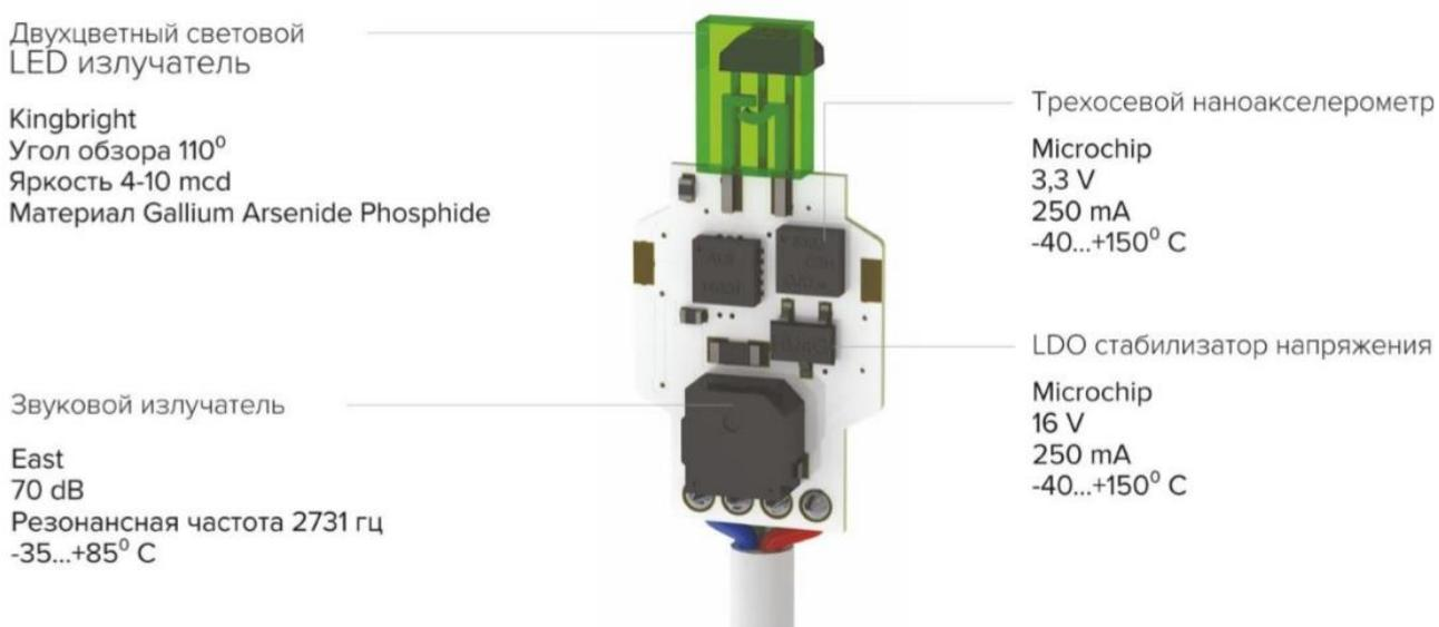
Рис. 2. Плата извещателя. Сторона 1.
