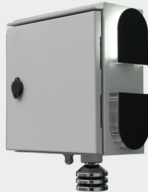
Станция представляет собой металлический бокс, в котором находится измерительный модуль, блок питания, микроконтроллер и модем GSM / NB-IoT. Поддерживает подключение до 30 дополнительных внешних измерителей. Обмен данными и питание дополнительного оборудования осуществляется по 4-х проводной адресной линии длиной до 1 000 м
